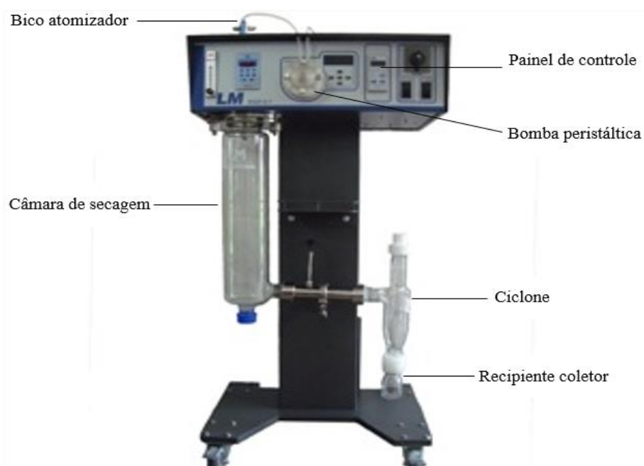
Figura 4 – A) Imagem do equipamento spray dryer utilizado na microencapsulação do óleo essencial de orégano, B) Esquema representativo da secagem por atomização no equipamento spray dryer.
