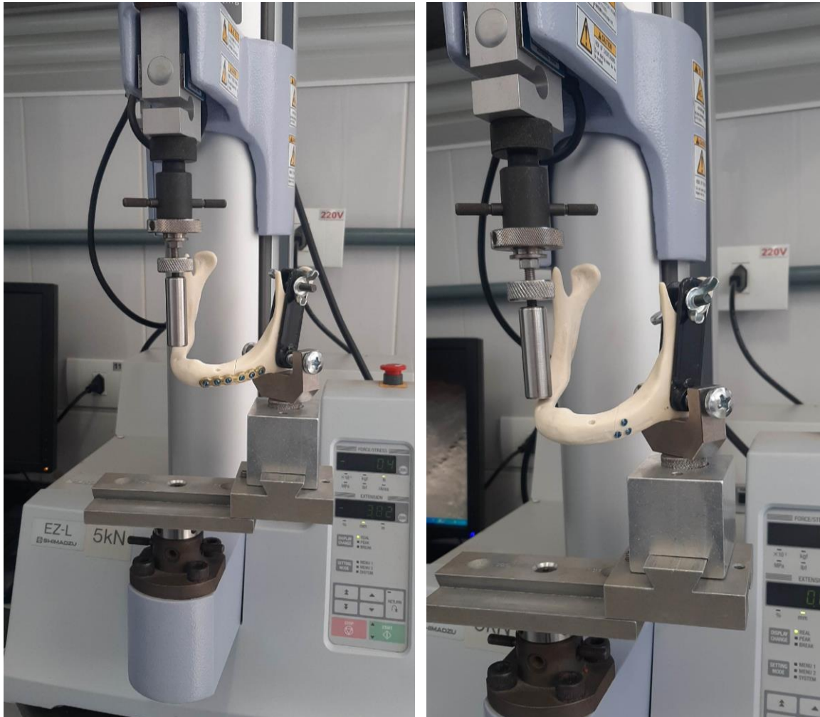
Figura 6: Mandíbulas inseridas na máquina de ensaio universal EZ-L através de um suporte customizado.
