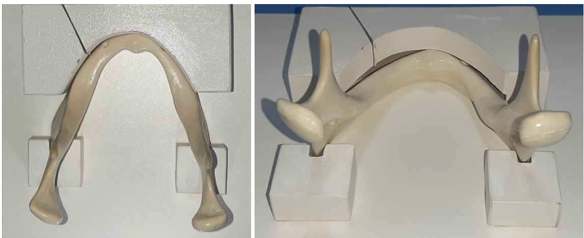
Figura 4: Suporte em mdf para acomodação dos corpos de prova guia de corte padronizado que simula a fratura do corpo mandibular.
