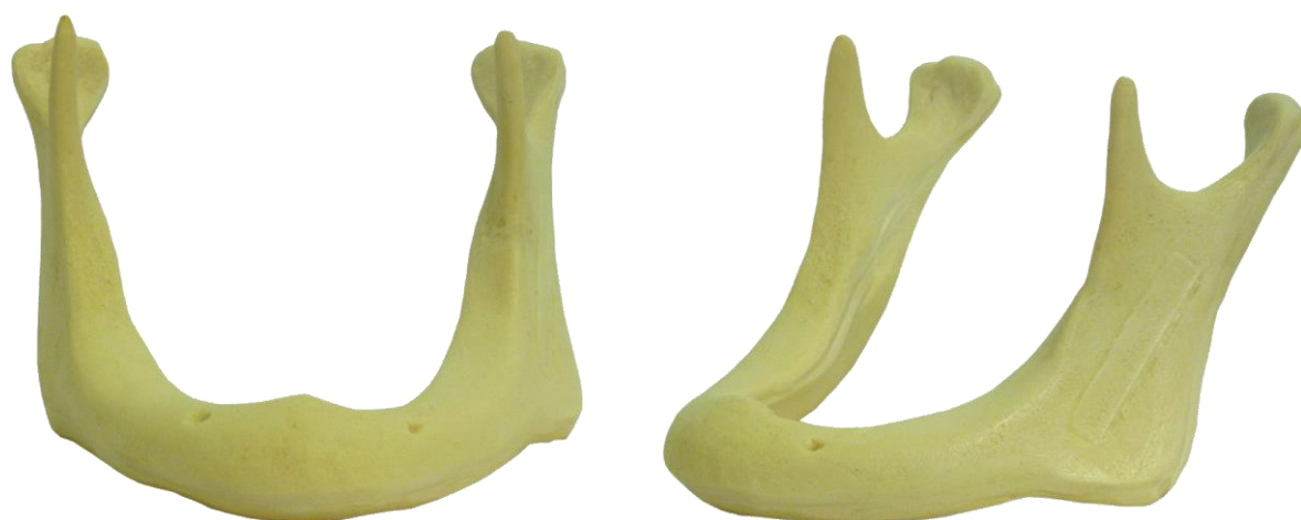
Figura 1 – Mandíbula edêntula e atrófica (Grau II) utilizada nos testes de resistência, confeccionada em poliuretano.
