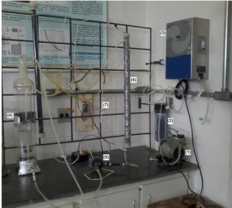
Figura 3.1 Conjunto experimental utilizado no estudo de remoção e degradação, que consiste de: (1) Compressor; (2) Dessecador; (3) Ozonizador; (4) Frasco reacional; (5) Bomba centrífuga de 30 W (6) Reator fotoquímico anular; (7) Coletor de amostra.
