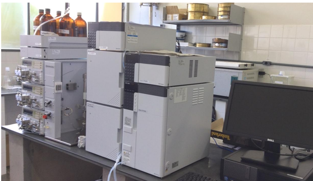
FIGURA 11 – Foto do cromatógrafo líquido de alta eficiência (HPLC) usado nas análises cromatográficas para comparação da metodologia
