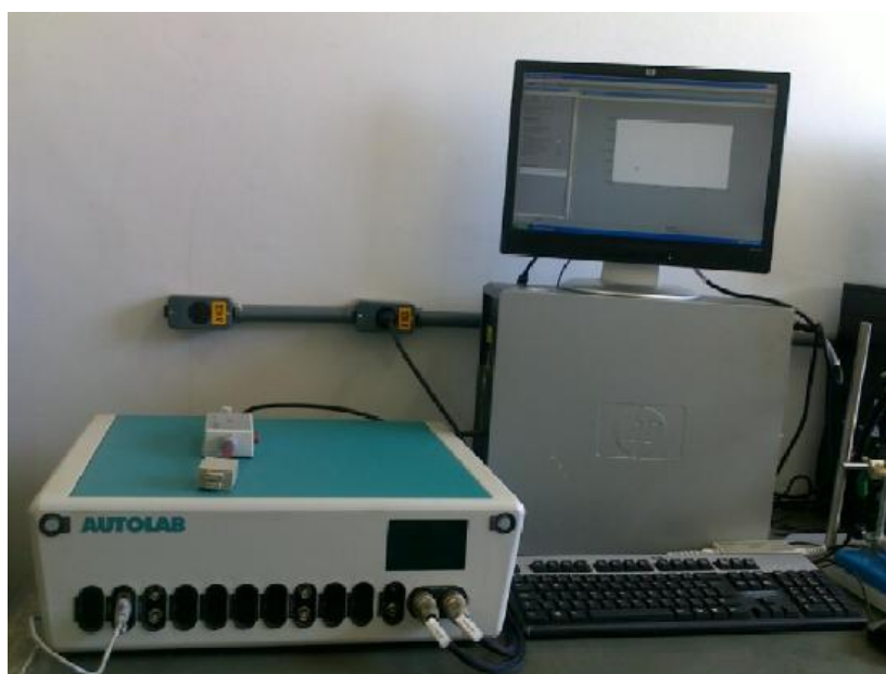
FIGURA 8: Potenciostato/galvanostato da Autolab modelo PGSTAT 128N.
