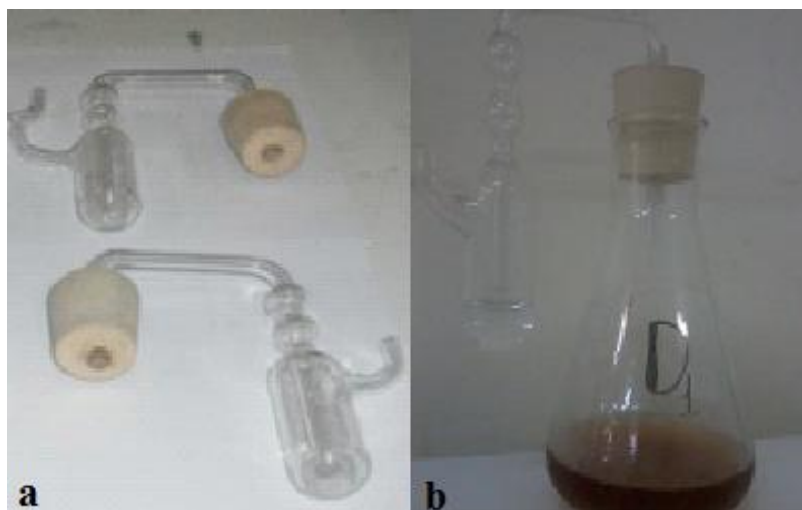
Figura 16 – Sistema de fermentômetro utilizado no processo de fermentação. a) Dispositivo fermentômetro e b) aspecto do sistema de fermentômetro acoplado a um Erlenmeyer.
