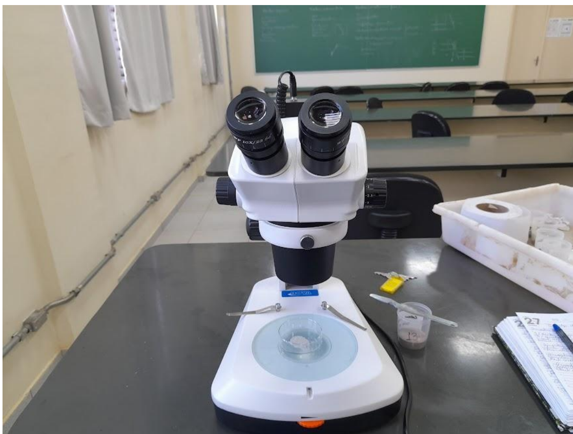
Figura 9: Lupa estereomicroscópica utilizada para análise mineralógica da fração areia.
