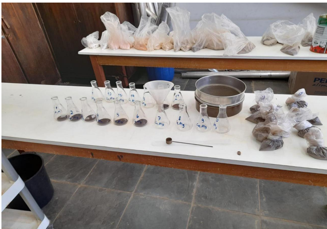
Figura 10: Amostras dos sedimentos colocadas nos béqueres para extração de K, P, Ca e Mg.
