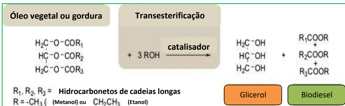
Figura 2 - Produção de biodiesel: reação de transesterificação
