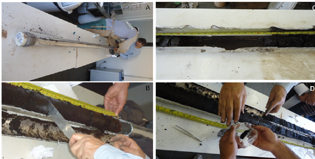
Figura 6. A: abertura dos tubos de coleta de solo; B: amostragem; C: descrição dos testemunhos (detalhe da presença de um bolsão d'água); D: condicionamento das amostras em sacos plásticos.
