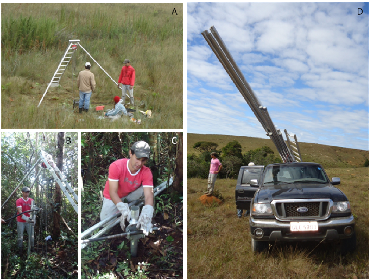
Figura 5. A, B, C e D: Amostragem do testemunho com o uso do vibrotestemunhador.
