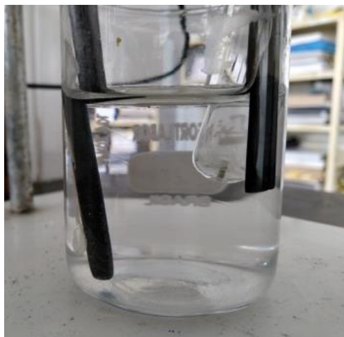
Figura 10 – Célula eletroquímica de 3 eletrodos.
