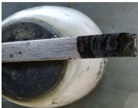
Figura 9 – Eletrodo de trabalho: filme de óxido sobre a chapa de titânio.
