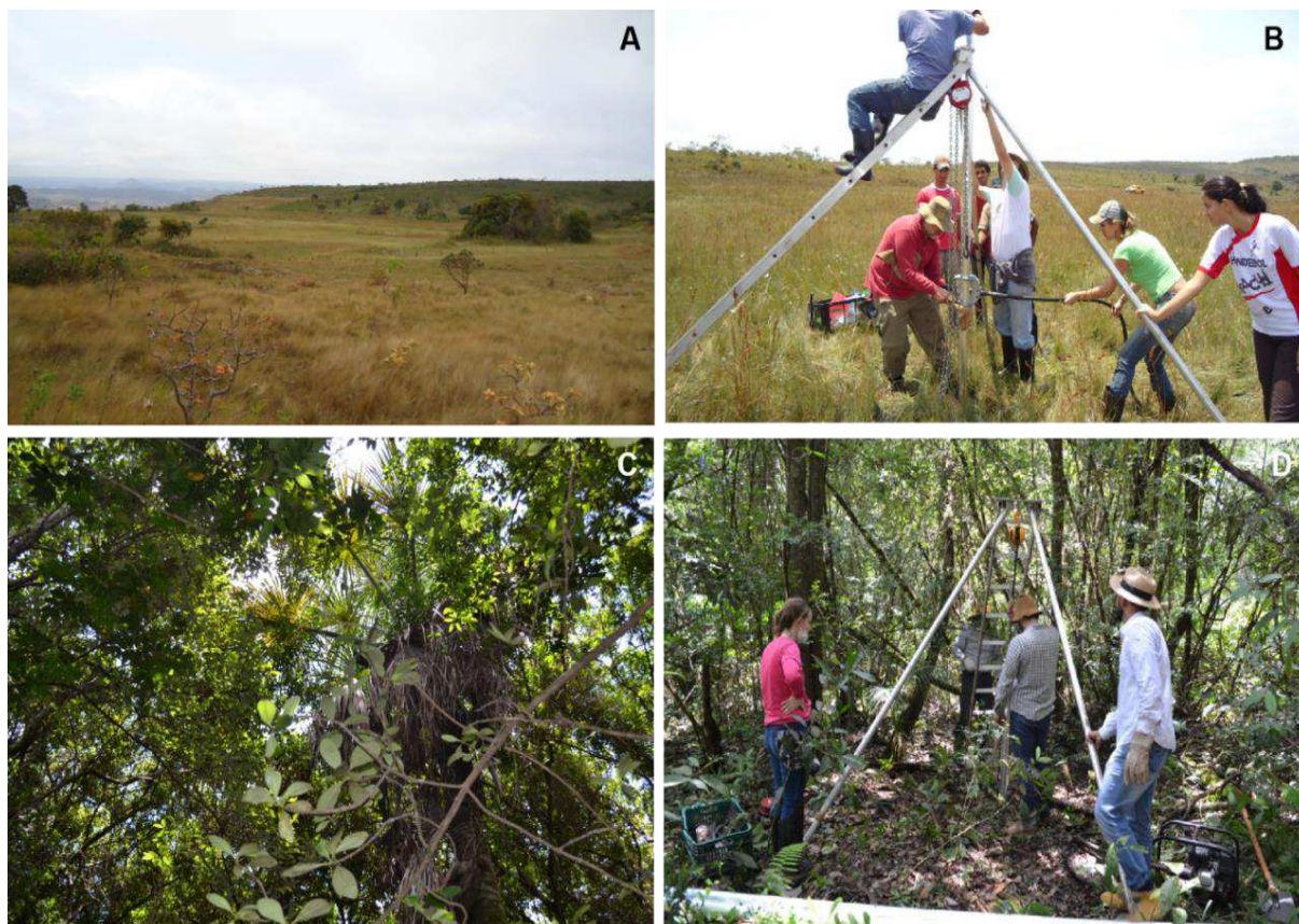
Figura 2. A e B. Turfeira São João da Chapada. B. Coleta do testemunho SJC com uso do vibrotestemunhador. C e D. Vereda Parque Nacional de Brasília. D. Coleta do testemunho PNB também com uso do vibrotestemunhador.
