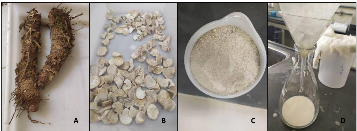
Figura 3 - Tubérculo da Alocasia macrorrhizos (A); Cortes do tubérculo após aquecimento em estufa (B); Tubérculo moído (C); Filtragem do processamento do tubérculo (D).
