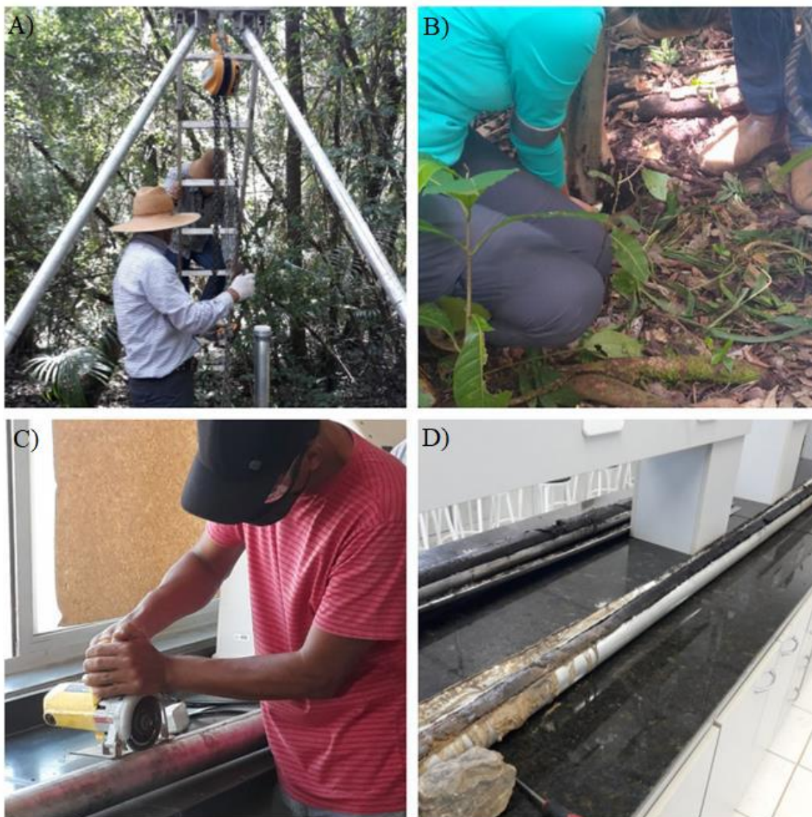
Figura 5 - Procedimento para coleta do solo com auxílio do vibrotestemunhador e abertura do tubo em laboratório
