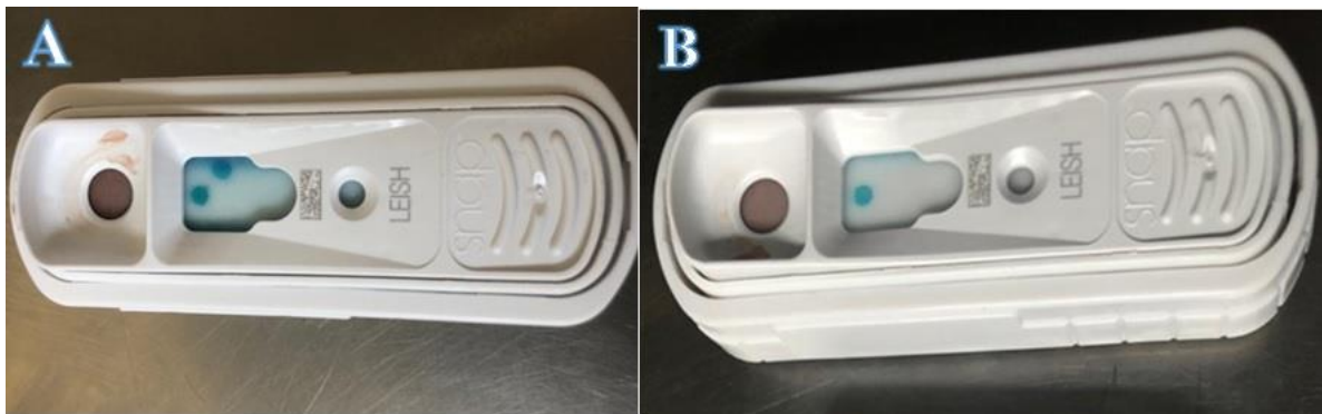
Figura 16 – Dispositivo de TR ELISA SNAP®/IDEX com resultado positivo A (Amostra Positivo) e com resultado negativo B (Amostra Negativa)
