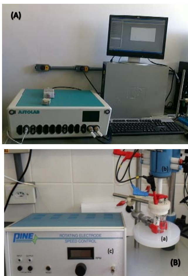
FIGURA 15: Potenciostato 128 N da Autolab (A); Aparato para realização da Voltametria Hidrodinâmica de Varredura Linear (B): célula eletroquímica (a), motor de rotação (b) e controlador de rotação (c).
