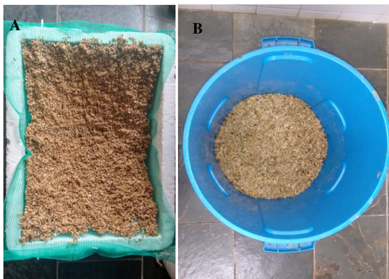
Figura 1 - Opérculos de cera: A) secagem após a limpeza; B) homogeneização dos opérculos pré amostragem
