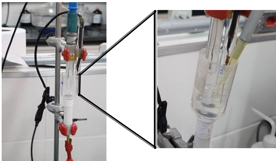
Figura 7: Célula eletroquímica com capacidade de 5,0 mL utilizada nos experimentos.
