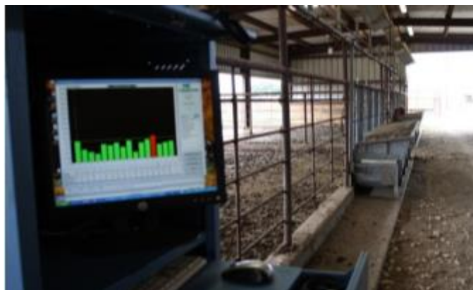
FIGURA 5. Programa de aquisição de dados: as barras representam o alimento no cocho; barra em vermelho indica a presença do animal no cocho. Fonte: (MENDES, 2012).
