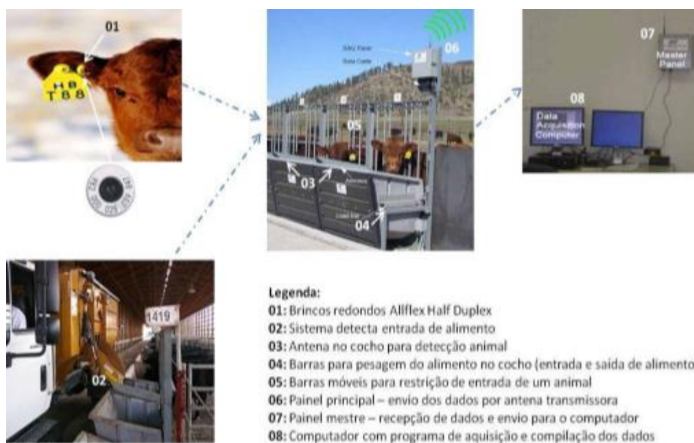
FIGURA 4. Representação dos componentes do GrowSafe ® System. Fonte: (MENDES, 2012).
