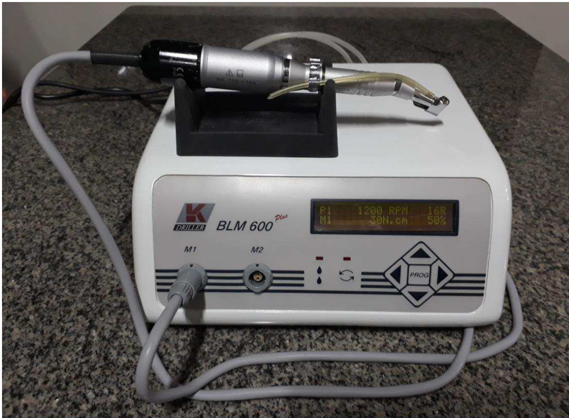
Figura 3 - Contra-ângulo cirúrgico (CONCEPT; redução 1:16) acolpado a motor cirúrgico (BLM 600), programado com 1200 rpm e torque de 30 N, para a confecção dos defeitos ósseos.
