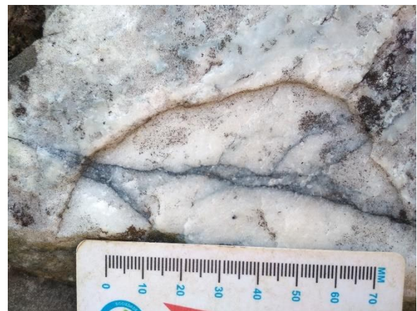
Detalhe para a variação de disposição dos níveis fosfatados, podendo acompanhar ou não o acamamento sedimentar.
