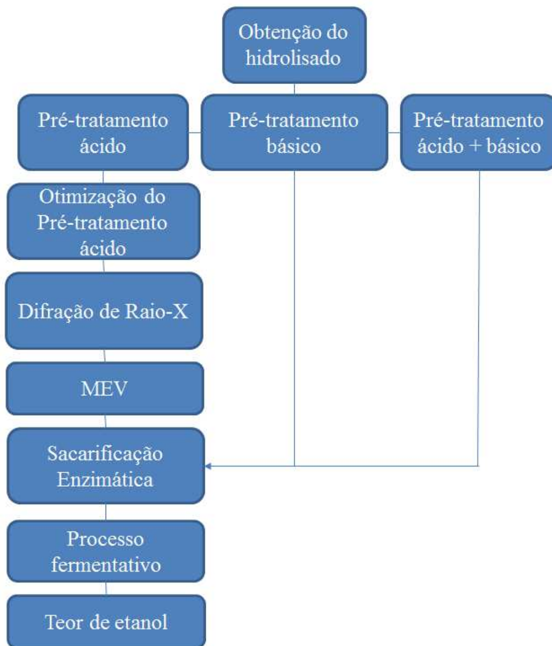
FIGURA 13–Fluxograma das etapas de obtenção do hidrolisado e produção de etanol de segunda geração a partir da Aguapé ( Eichhornia crassipes ). Fonte: Autor
