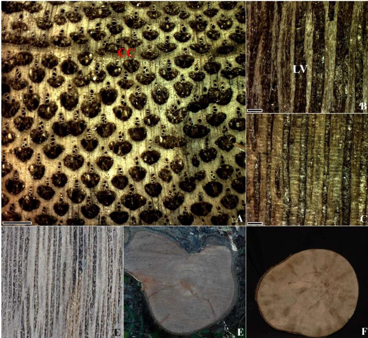
Figura 119 - Fotografias macroscópicas da espécie Guapira opposita . Barra = 1 milímetro. A) Plano transversal destacando a camada de crescimento (CC). B) Plano longitudinal tangencial destacando linha vascular (LV). C) Plano longitudinal radial. D) Cor da madeira observada na superfície longitudinal. E) Plano transversal após o corte em campo. F) Plano transversal após 13 meses.
