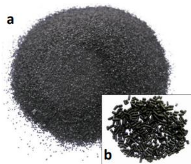
Figura 10 - Carvão ativado: a) moído, b) granulado.
