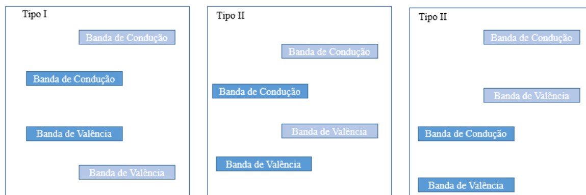
Figura 1.8 - Os três tipos de alinhamento possível na formação de heteroestruturas.
