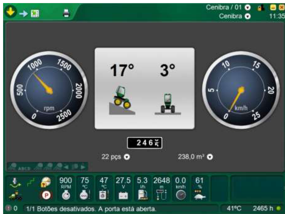
Figura 9 – Imagem ilustrativa da tela do computador de bordo do Forwarder , sistema TimberMatic .
