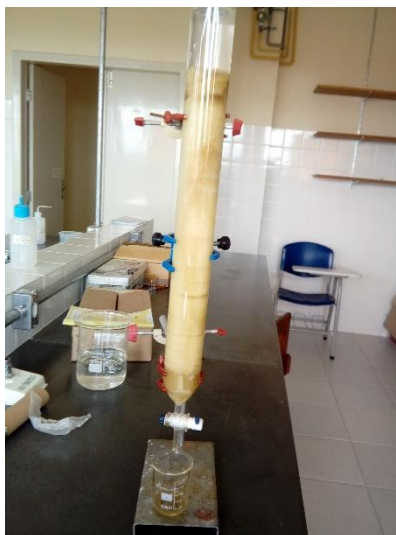
Figura 6 - Coluna cromatográfica clássica- cromatografia preparativa por adsorção (fase móvel: gradiente de polaridade; fase estacionária: sílica gel 0,050-0,20mm)
