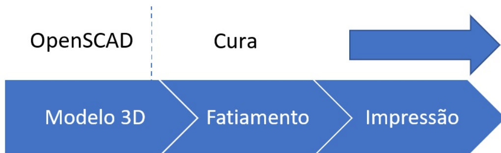
Figura 52 – Fluxo de trabalho geral de impressão 3D com OpenSCAD e Cura
