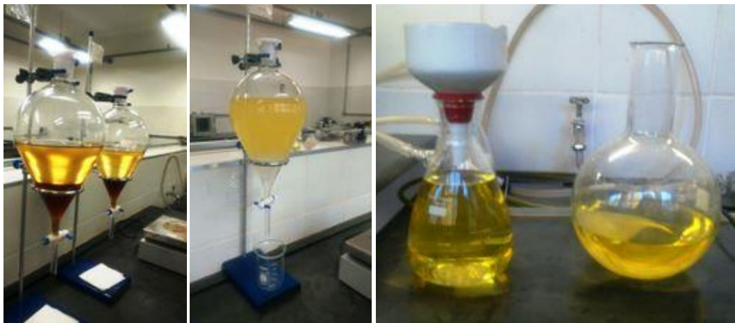
Figura 8 – Produção do biodiesel metílico de OAM.
