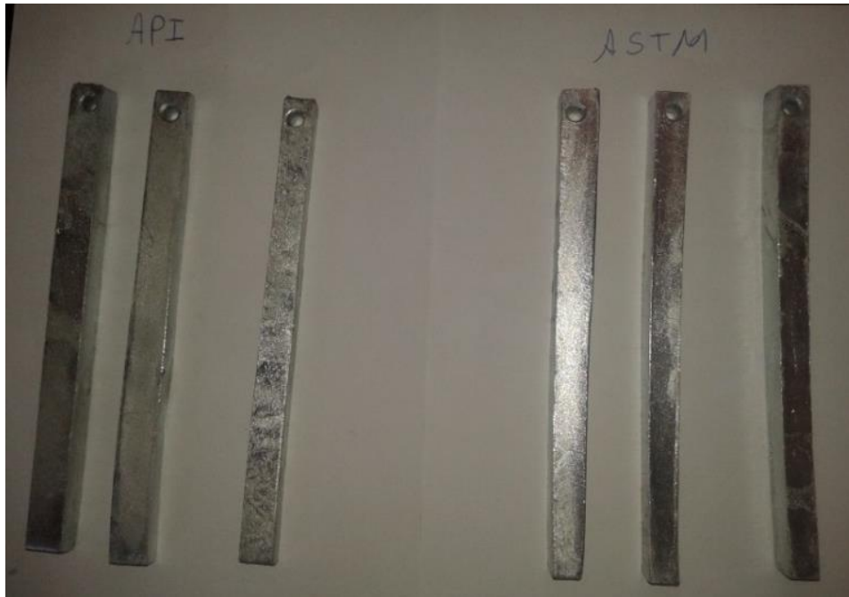
Figura 7 – Barras dos aços AG API e AG ASTM galvanizadas
