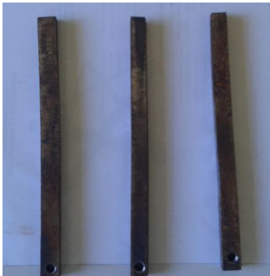
Figura 6 – Barras de aço AC API após o corte
