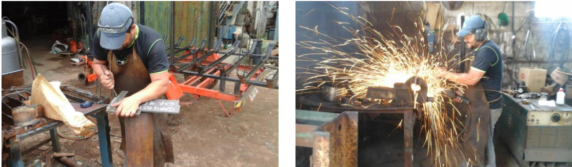
Figura 5 – Cortes das placas de aço em barras
