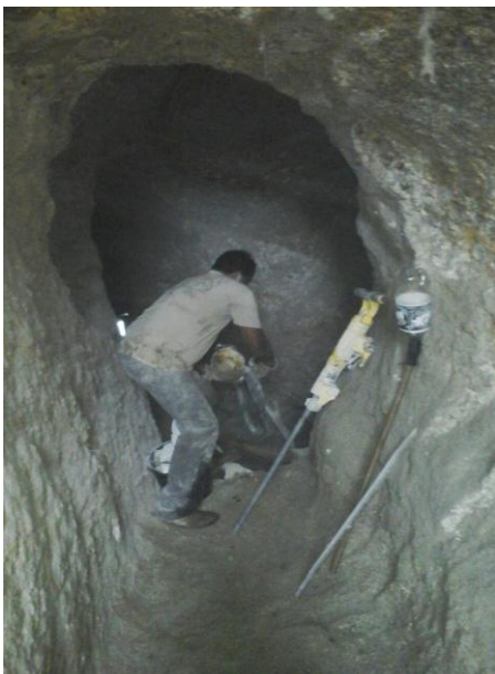
Figura 12 – Rocha dura, garimpeiro utilizando o martelo para perfurar a área Fonte: Repositório digital da autora
