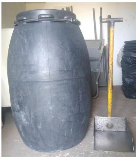
Figura 4: Pá de metal e “bombona plástica” com capacidade de 200 litros para coleta do carvão vegetal.
