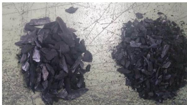
Figura 7: Finos de carvão vegetal com granulometria menor que 9,52mm. À esquerda material retido na peneira de 6,32mm e a direita material retido no fundo.
