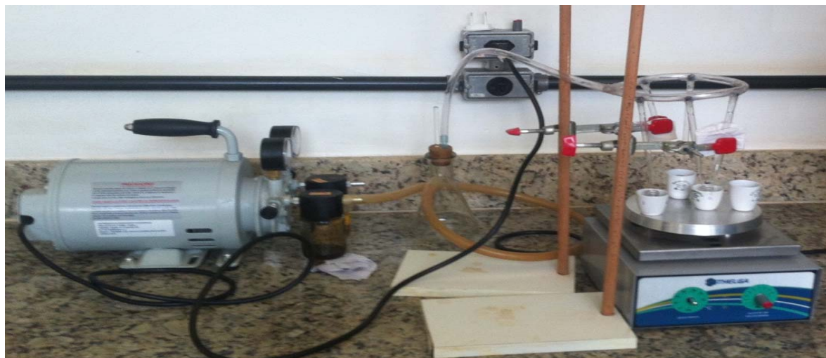
Figura 7: Fotografia do processo de secagem dos extratos.
