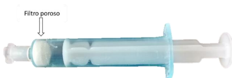
Figura 10: Foto ilustrativa da seringa de polipropileno utilizada para a síntese.
