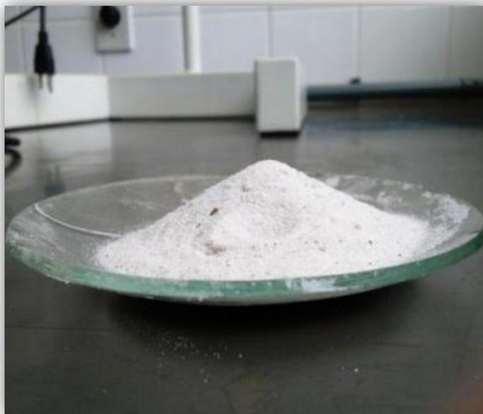
Após a padronização a sílica foi dividida em duas partes contendo 100 g cada, as quais foram novamente levadas a calcinação por 4 horas, uma a 400 e a outra a 700° C, sendo a partir de então nomeadas S<sub>400</sub> a que foi calcinada a 400° C e S<sub>700</sub> a alíquota que recebeu tratamento térmico a 700° C.
